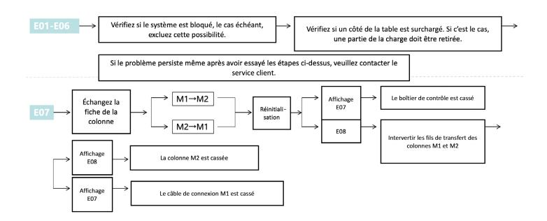
**Remarque :** La méthode de traitement du rapport d'erreur E07-E 12 est la même. Il est nécessaire de vérifier si la ligne de connexion de la colonne correspondante est normale et si la connexion est fiable, y compris entre le câblage de non-transfert de la colonne et le câblage de non-transfert du contrôleur.
