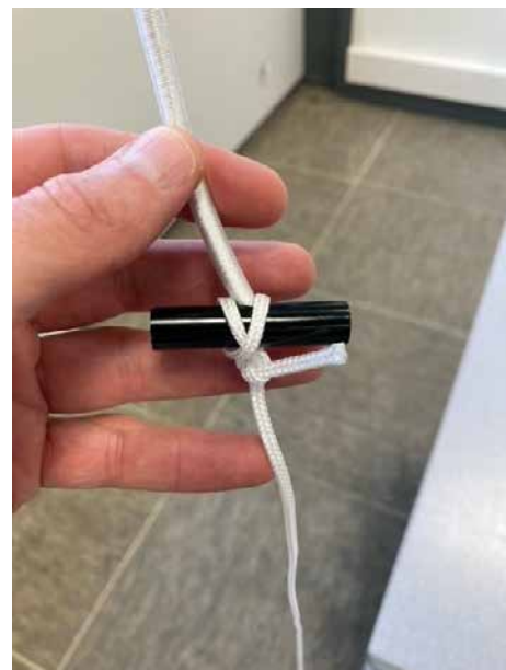
62h Bien tendre le nœud. Attention , ne pas utiliser un autre type de nœud.
