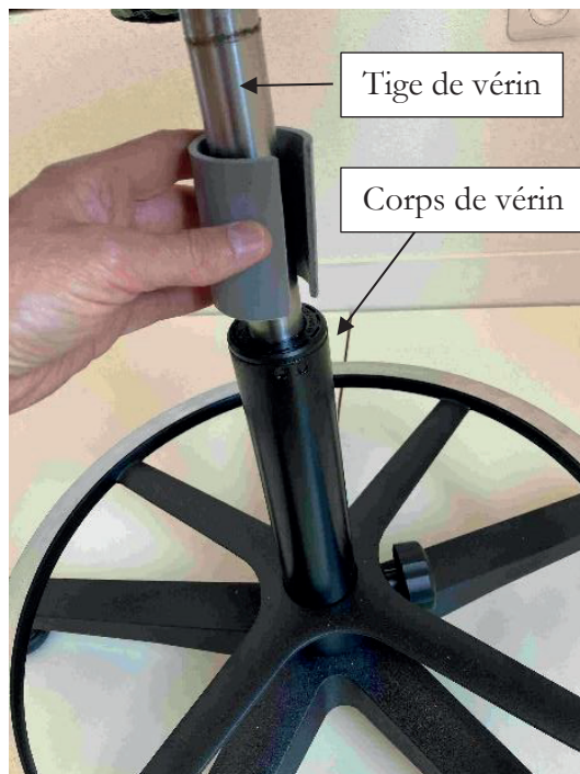
Image 7 : ... passer la bague plastique sur la tige du vérin puis...
