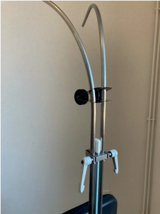
Image 26 : en pinçant les poulies, faite les glisser approximativement comme sur l'image.
