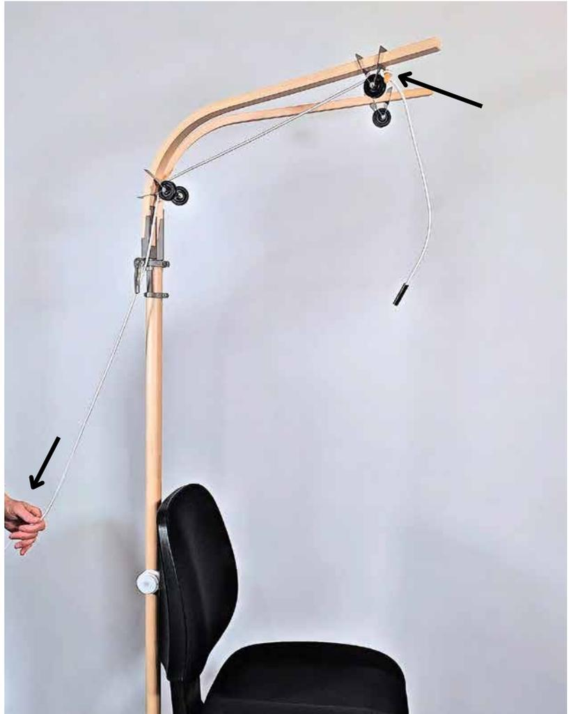
Image 28 : passer les élastiques dans les poulies, les boutons-tonneaux en butée contre les poulies.
