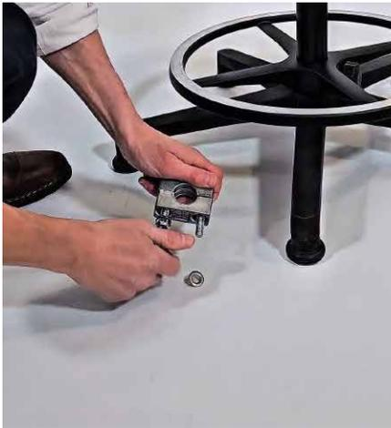
Image 6 : préparer la paire de mâchoires et la plaque de recouvrement.
