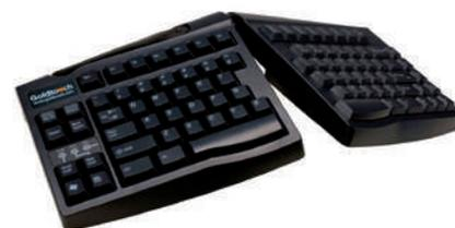
Le clavier Goldtouch est muni d'une articulation centrale permettant d'obtenir des orientations différentes entre les parties gauche et droite. La position des mains et avant-bras est beaucoup plus proche du référentiel anatomique. Cette posture permet de solutionner certaines difficultés de mobilité, incompatibles avec l'utilisation d'un clavier traditionnel.
